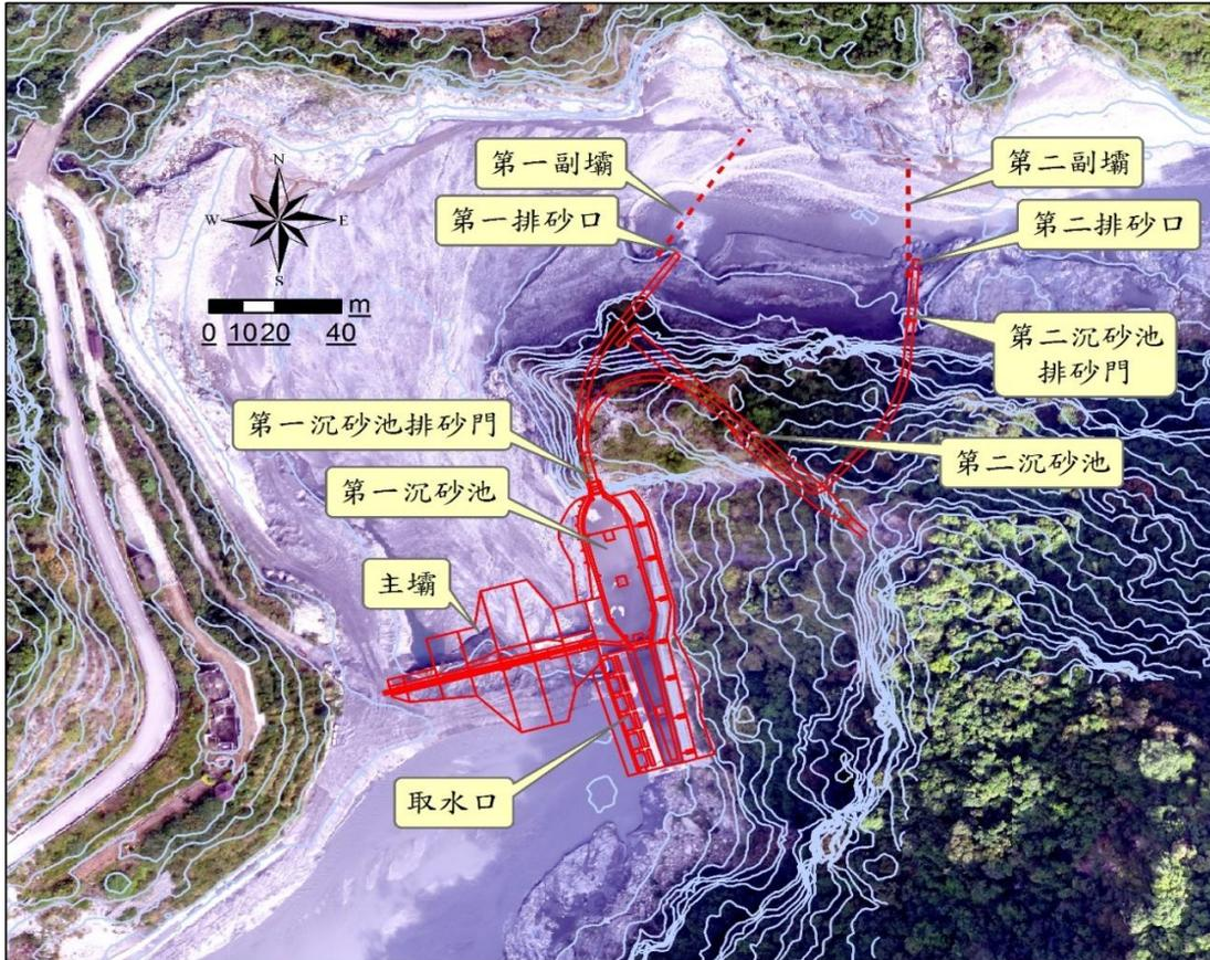
圖5-6-11 臺東卑南上圳取水口設施改工程既有設施圖
