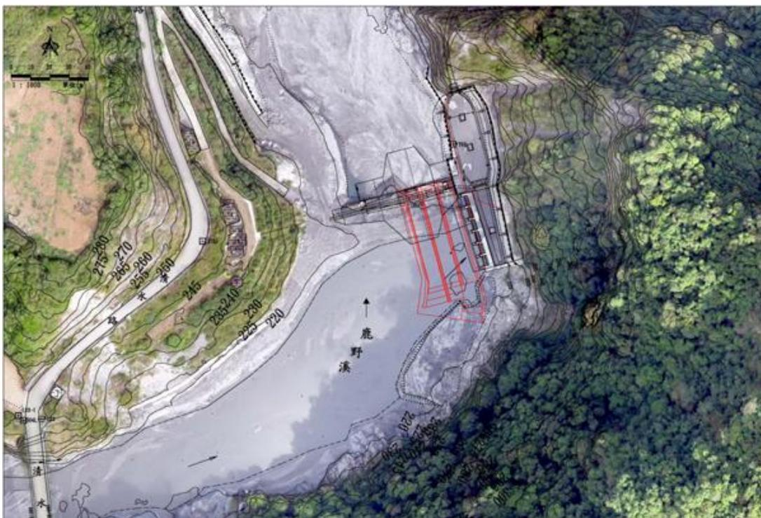
圖5-6-12 臺東卑南上圳取水口設施改工程河道排砂道改善方案平面配置圖 I
