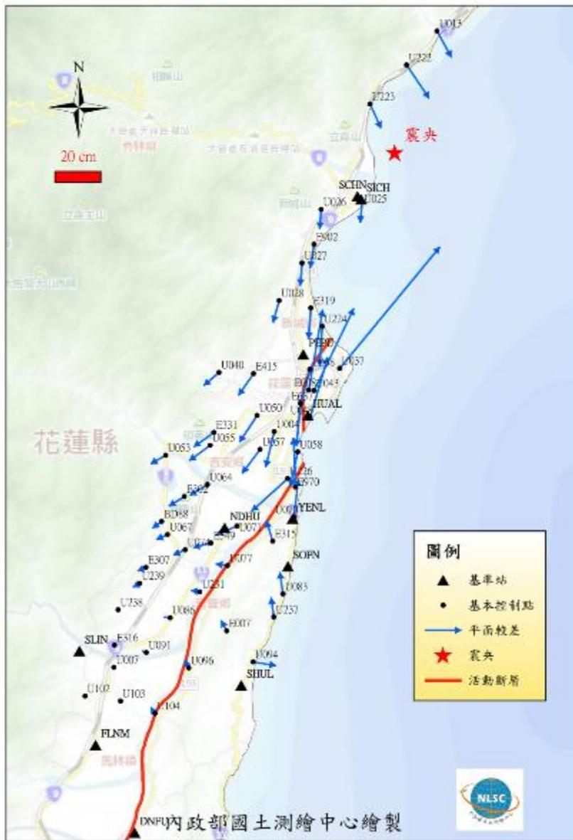
圖 5-5-1 行動計畫 5.1 內政部國土測繪中心檢測成果與公告成果平面分量較差示意圖
