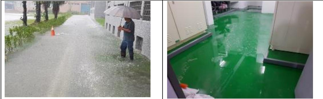
操場週邊大量水泥鋪面，排水不佳，造成地下室淹水嚴重，機電設備有漏電的危安問題
