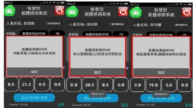
▲ 「無線氣體感測器」具備手動警報、墜落警報、靜止警報及氣體異常警報
