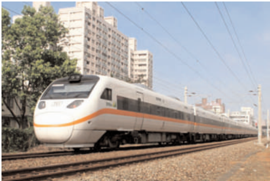
台鐵傾斜式列車「太魯閣號」，可配合彎曲路段側向擺動，大幅縮減行車時間。
