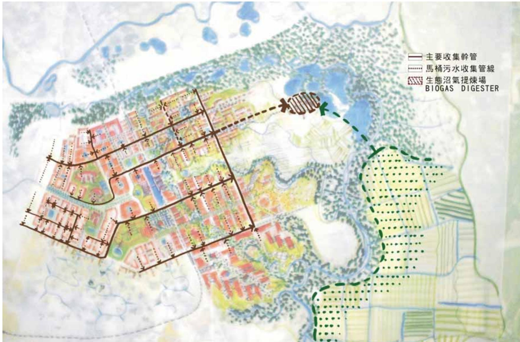
圖 7-9 污水回收系統示意圖
