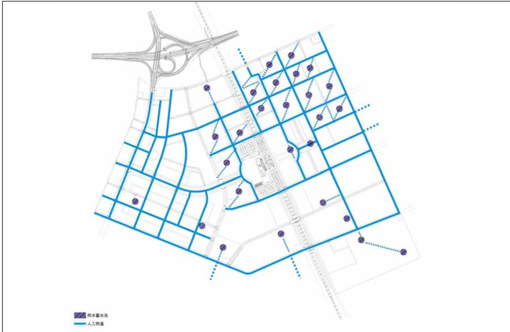
圖 10-12 雨水回收系統圖
