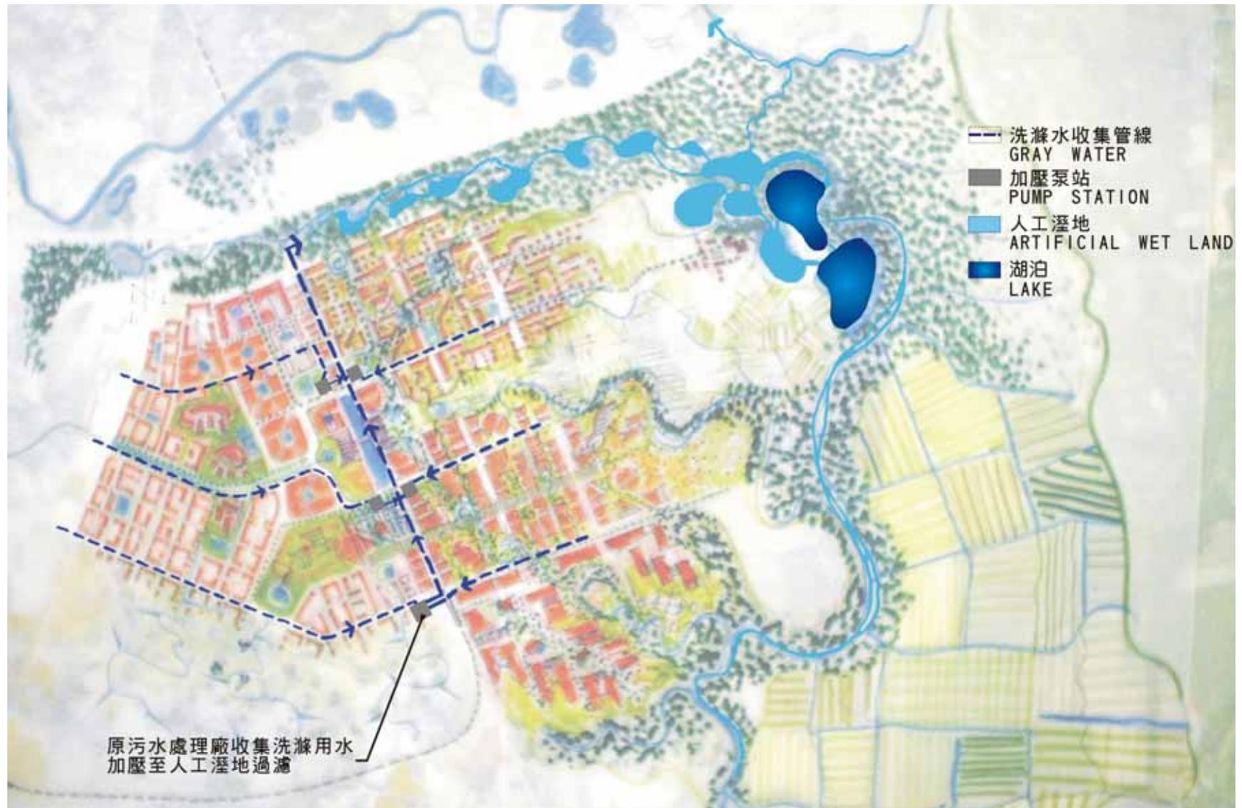
圖 185 中水回收系統示意圖
