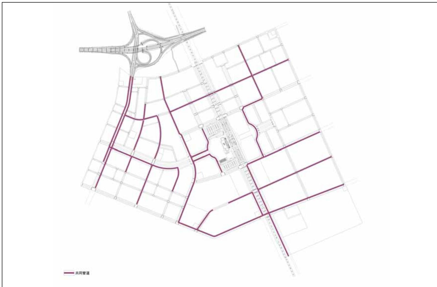
圖 10-16 共同管道系統配置圖
