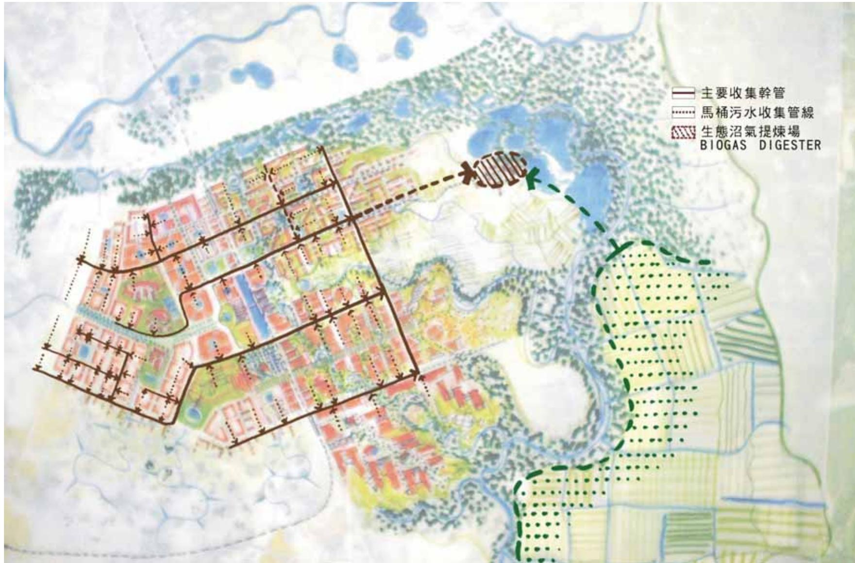
圖 186 污水回收系統示意圖
