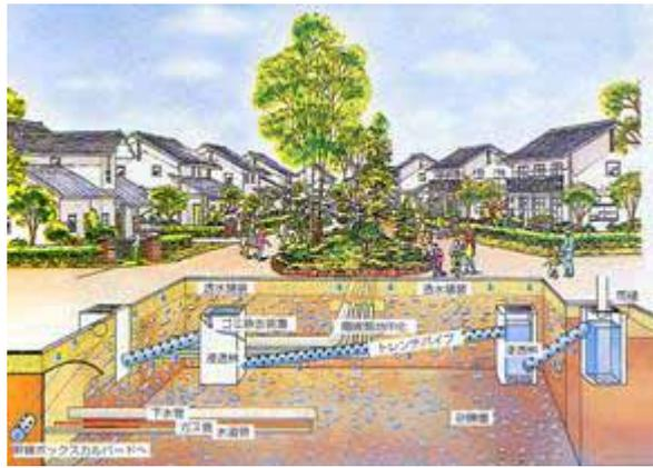
圖 5-23 水資源利用—雨水貯流浸透設施
