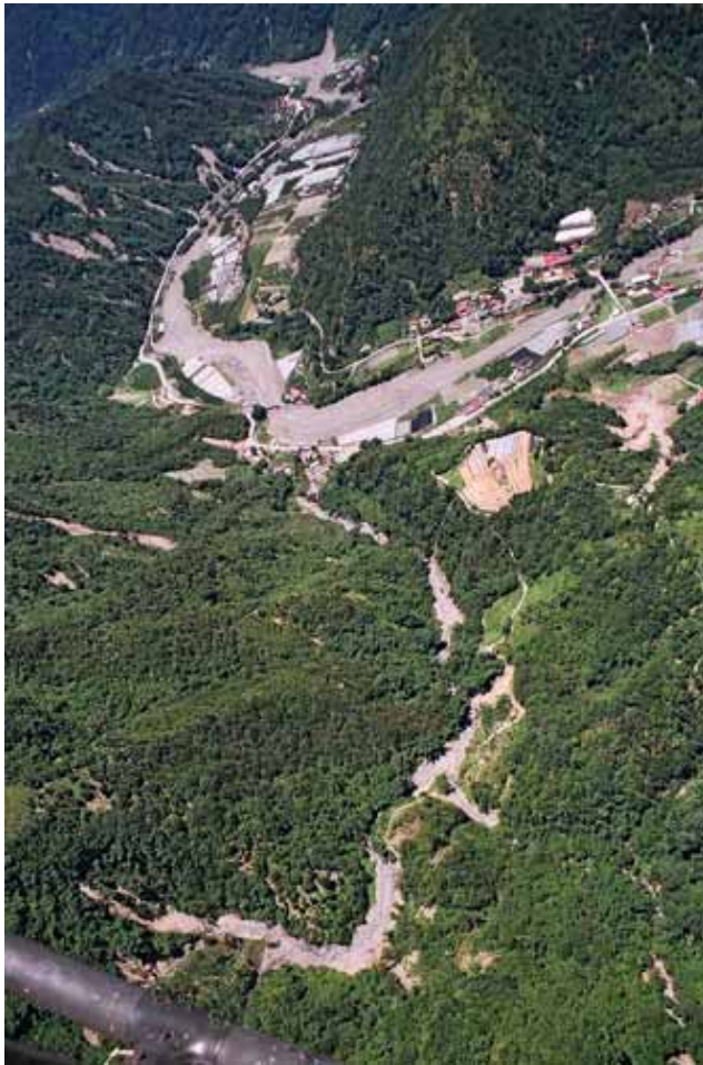
照片左：南投 005 土石流潛勢溪流全貌，下游為楓子林橋。眉溪於此處大轉彎，並於稍下游處眉溪河道突然縮減。照片右上方為同心橋，對岸即為南豐國小所在地，亦為南豐村之緊急避難所。照片右：南投 005 土石流潛勢溪流上游。野溪上游溪溝岩盤出露，崩塌多發生於右岸。
