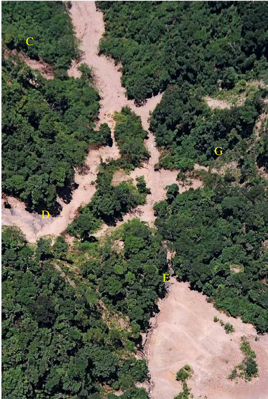
源頭之崩塌(E處)坡腳坡面岩盤已出露，且最上游溝谷中土石似乎已被逕流沖刷的相當乾淨。左岸崩塌區(D處)崩塌面岩盤亦已出露，至於右岸崩塌(G處)溝狀裸坡溝中似乎仍有部分土石未完全進入溪谷中。
