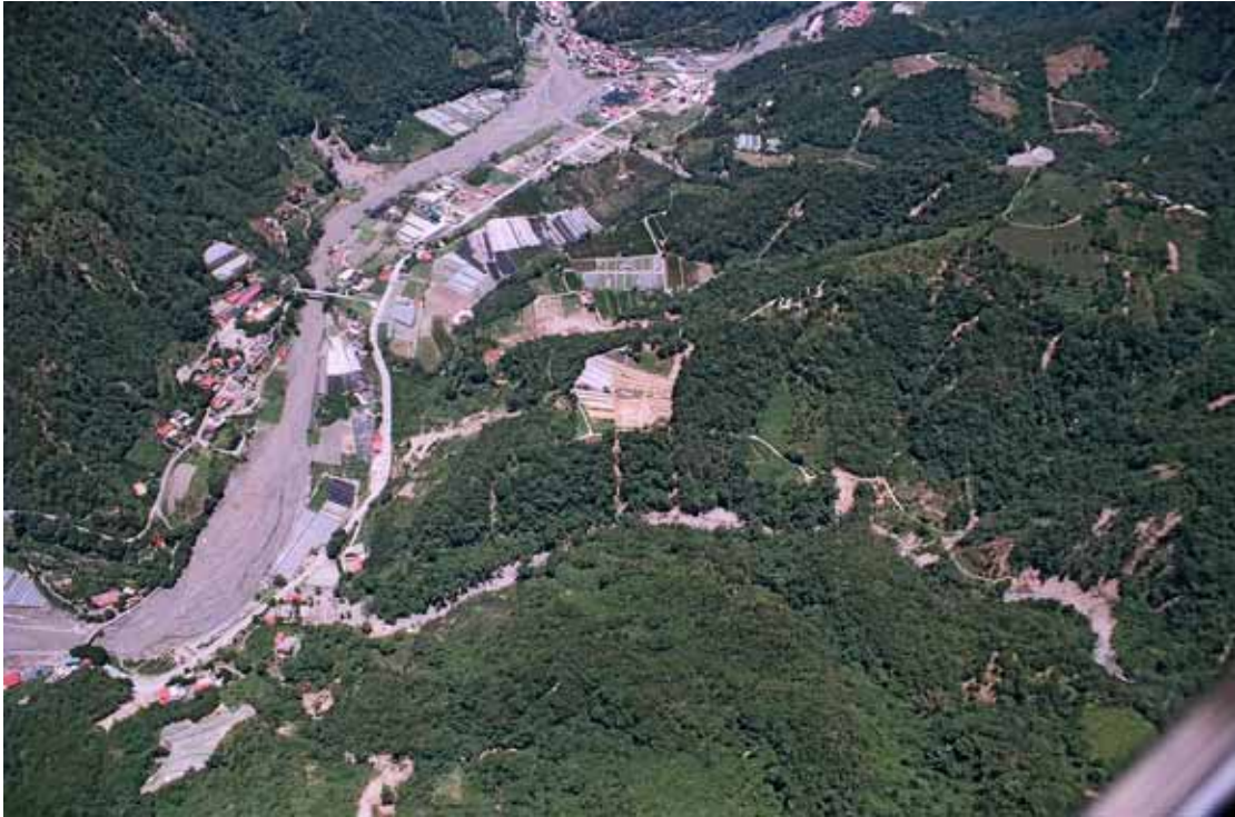
投 A003 土石流潛勢溪流屬坡面崩塌形成之蝕溝。地形上原即為一凹坡。
