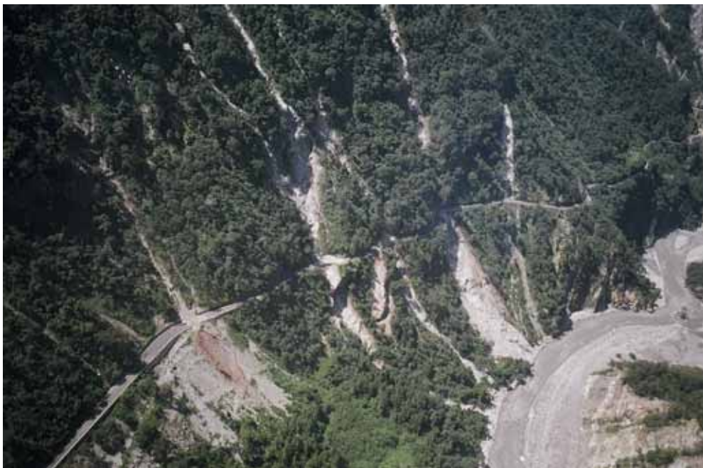
圖 3.25 台 8 線遭土石流損壞中斷情形[林美聆攝(2004/7/10)]
