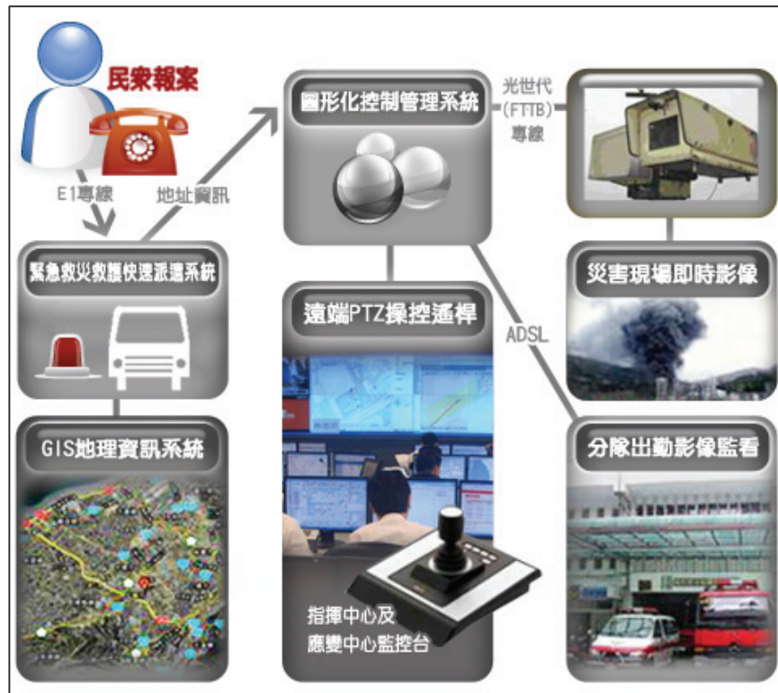
圖 44 智慧型高影像監控系統架構圖
