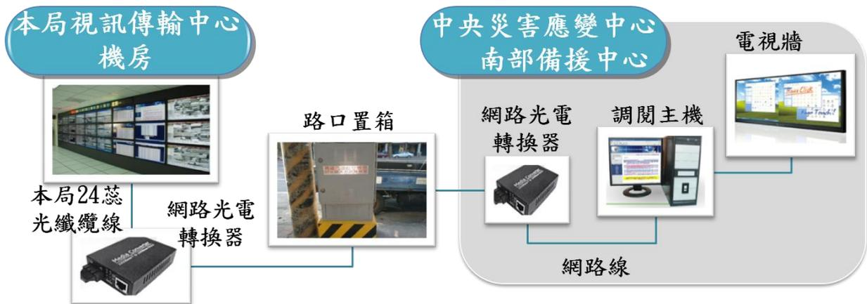
圖 2-9：中央災害應變中心南部備援中心介接本局視訊傳輸中心架構圖
