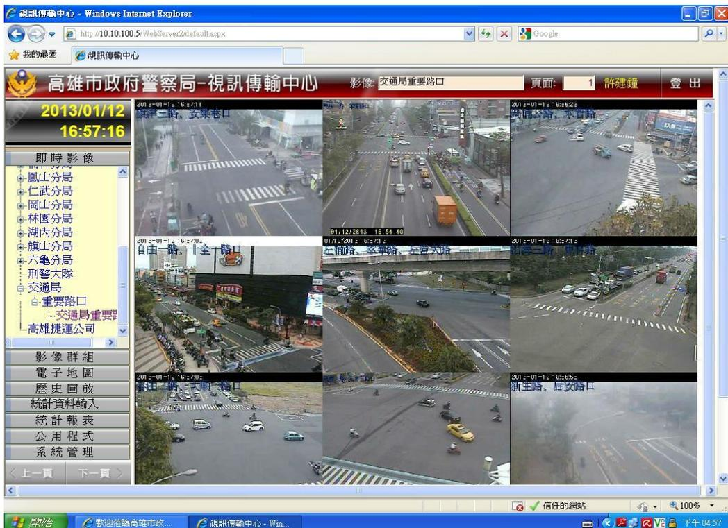
圖 2-6：交通局重要路口交通流量監控系統
