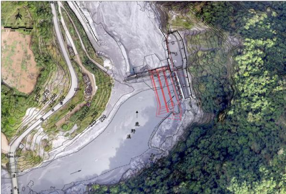
圖5-6-15 台東卑南上圳取水口設施改工程河道排砂道改善方案平面配置圖
