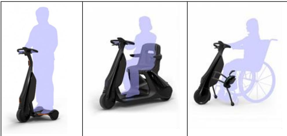
圖 5-2 由左至右分別為豐田汽車開發之站立型、乘坐型、輪椅連接型之步行領域EV智慧代步機
