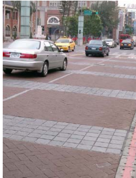
圖 2.1.23 以不同顏色陶磚標示道路分隔，並利用橫向視覺效果降低車速
