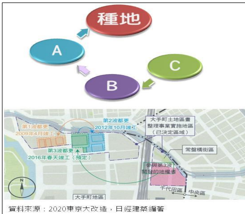
圖 3.1-1 日本撞球式的連鎖更新示意圖
