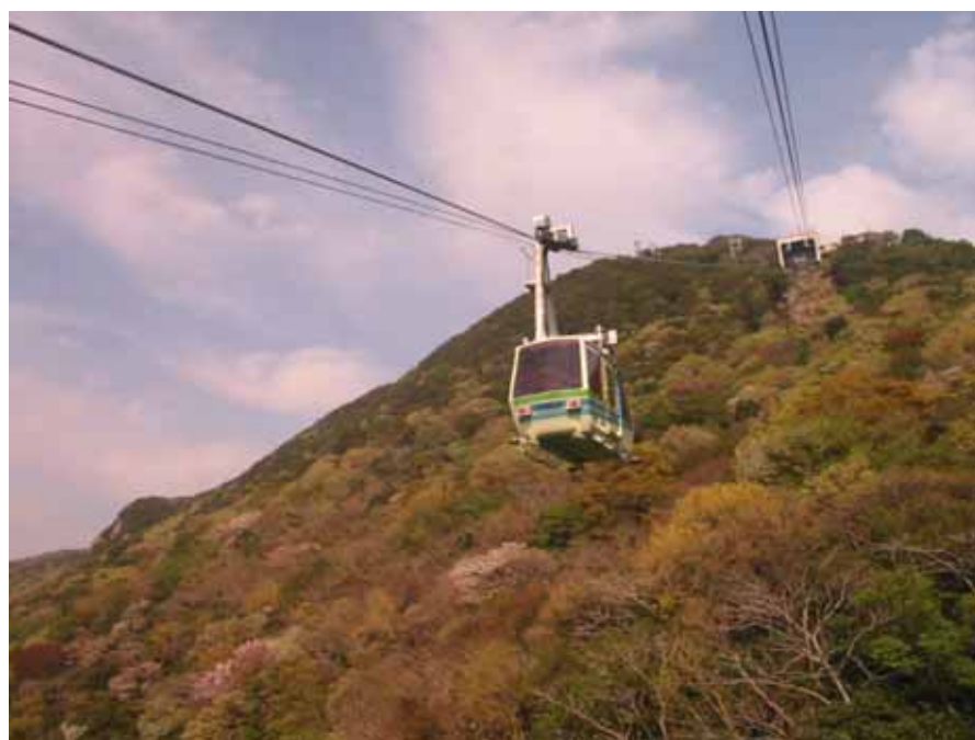
圖 8-3 新式纜車線架高維持原地面用途
