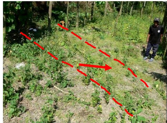
圖 2-2-77 瑪家活動中心上方位置之垂直位移約 30~40cm，水平位移約 25cm。（紅色點線為地滑裂縫）（陳天健，2009）
