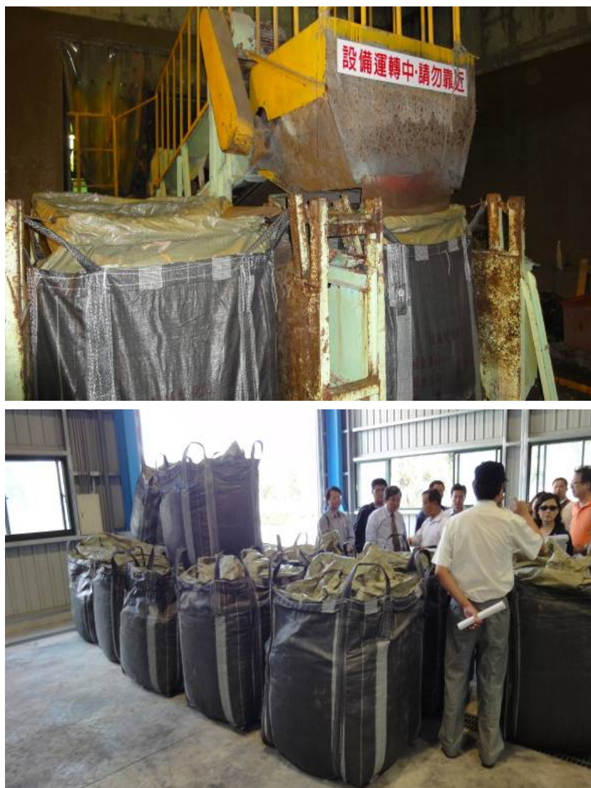
附圖 4-5 飛灰(a)排出與裝袋；(b)太空包貯存
