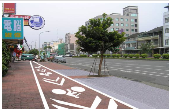
方案三:設置自行車道+機車停車灣
