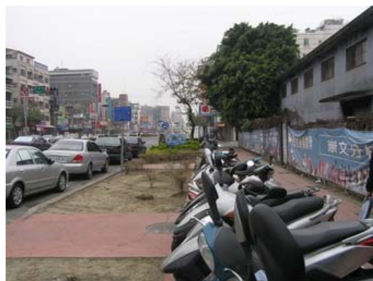
圖 6.1.10 垂楊路人行道空間配置不良，機車停車區與植栽佔用太多空間
